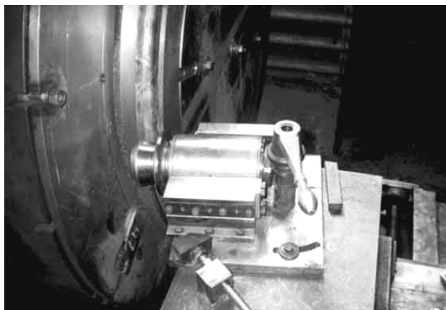
Рис. 3. Конструкция раскатной головки (а) и общий вид раскатной приставки к лобовому токарному станку (б):
